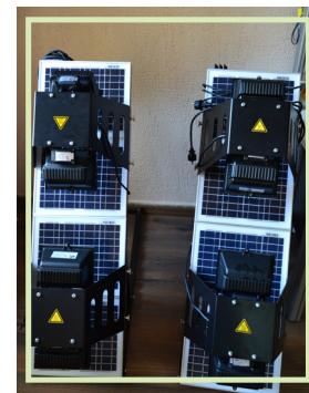
Фотоэлектрические панели с имитацией солнечного света
