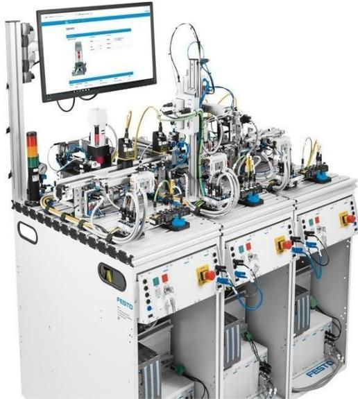
Компактный автоматизированный учебный комплекс для изучения основ Индустрии 4.0 включает три модифицированные специализированные станции на мобильных платформах. Комплекс позволяет группе студентов не только изучать технические элементы мехатронных станций, но и управлять производственным циклом с использованием MES-системы.
